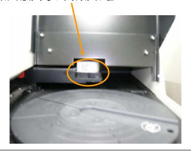
ChunkRot:調整吸盤(置放待測樣品的平台)的移動位置
